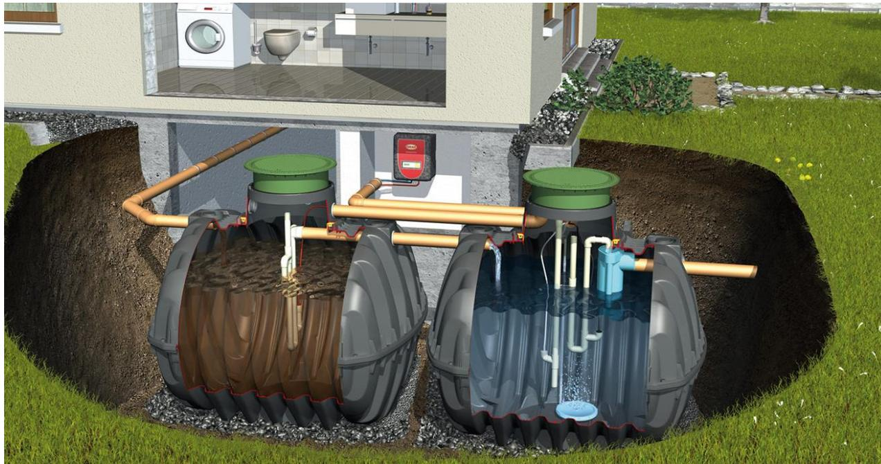
SBR-Anlagen sind vollbiologische Kläranlagen, die nach dem Prinzip des SBR-Verfahrens (Belebungsanlage im Aufstauverfahren) arbeiten.
